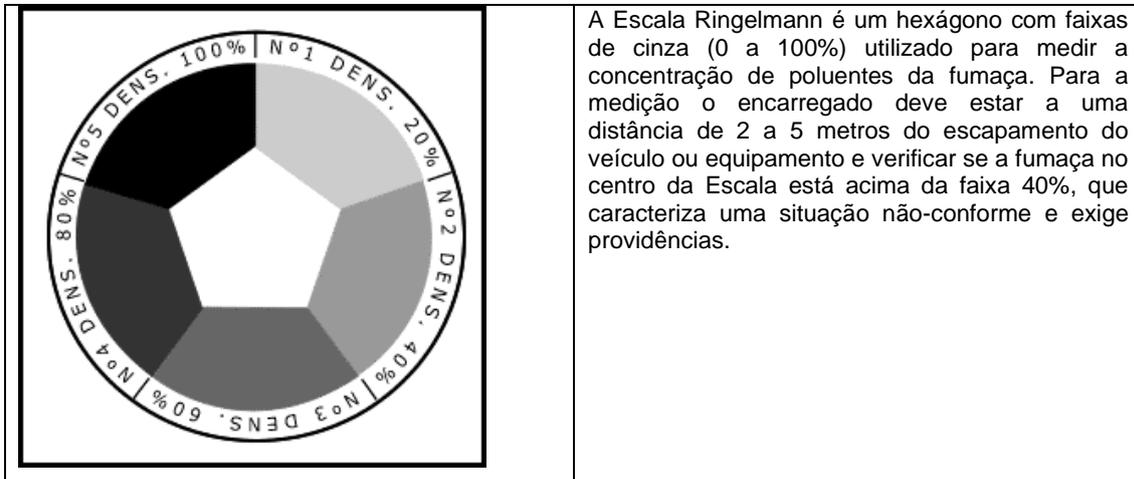
O monitoramento de fumaça preta para os veículos utilizados conforme norma ABNT NBR 10736. Para o caso de serem constatados níveis altos de emissão de poluentes em motores a combustão pelos métodos de medição definidos (Escala Ringelmann), é importante que a haja a adoção de medidas de avaliação de emissão para motores a combustão diesel, incluindo avaliação de NOx, SO2 e material particulado e adotadas medidas para que as máquinas e equipamentos atendam os parâmetros ou sejam substituídos.
